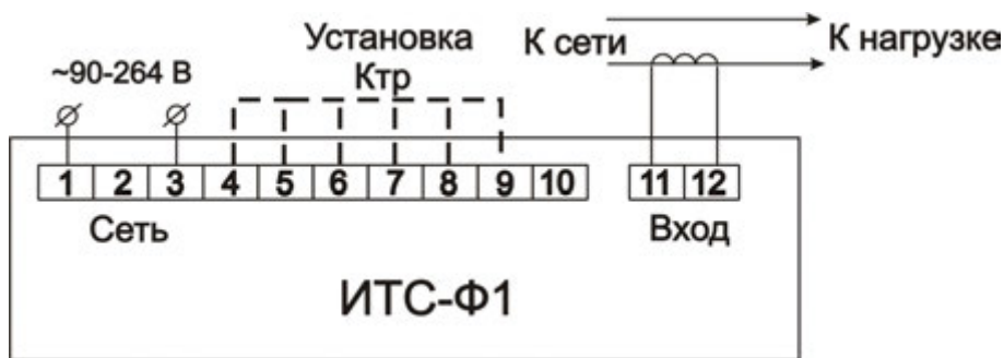
Рисунок Б.2 – Схема подключения прибора через согласующий трансформатор тока
